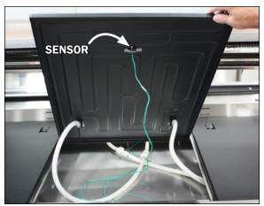
Fig. 3 Coolgenix pan sensor
