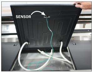
Fig. 18 Coolgenix pan sensor
